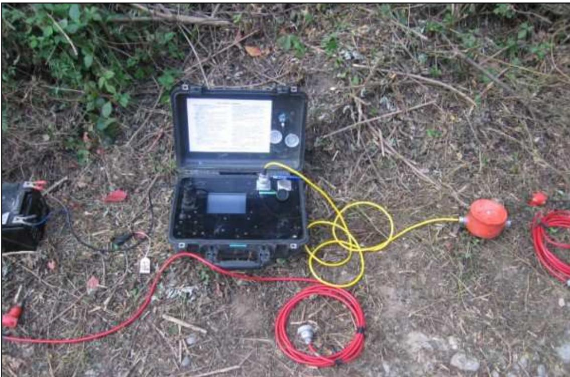
*Figura 1 - Sismografo EEG con geofono triassiale in fase di acquisizione*
